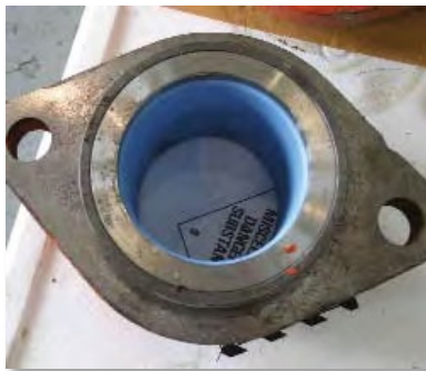
Подшипник ThorPlas, установленный в удерживающем воротнике
