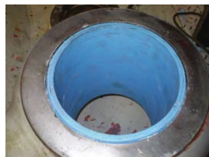
Модернизация White Rock с подшипниками ThorPlas без смазочного материала
