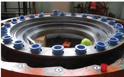
Подшипники для поворотного затвора ThorPlas
