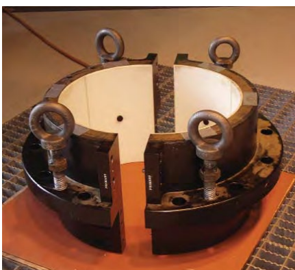
Подшипник основной направляющей Thordon SXL готов к установке на станции озера Стар
